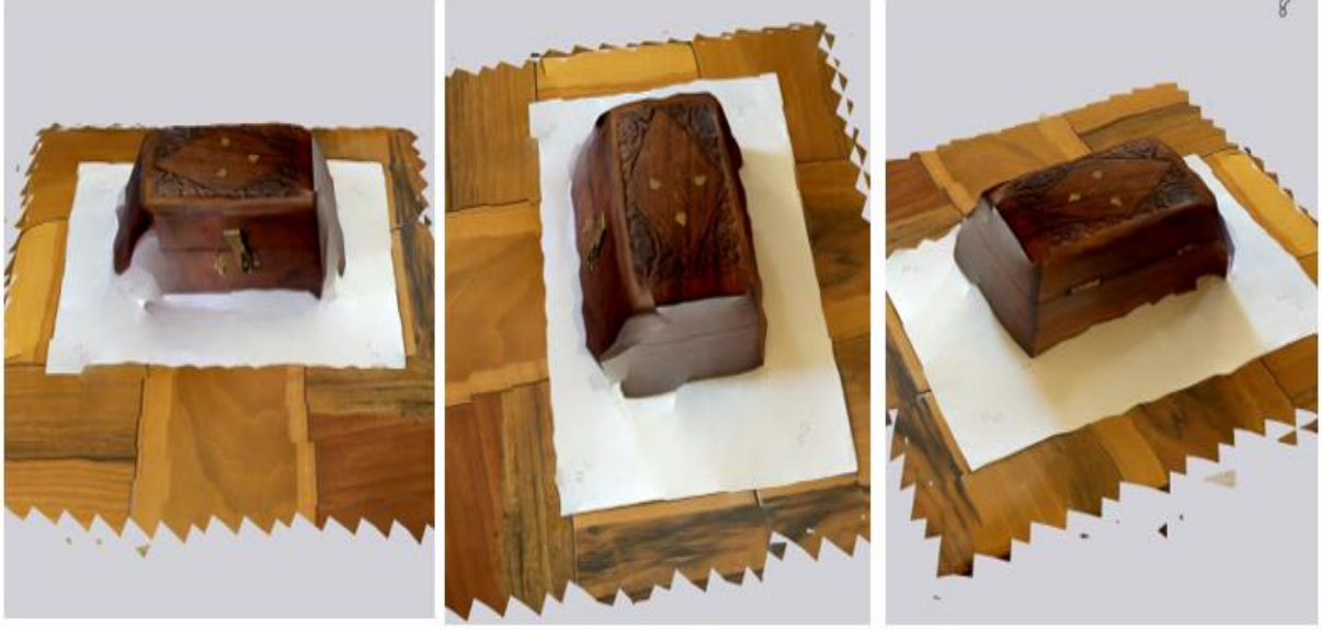
Şekil 8. LIDAR Advanced tarama modu ile elde edilen 3b model görseli
