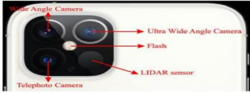
Şekil 1. iPhone 14 pro kamera ve sensör sistemi (Günen ve ark., 2023)
