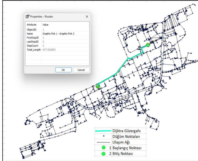
Şekil 5: Sağlıklı bireyler için Dijkstra algoritması (Rastgele noktalar için)
