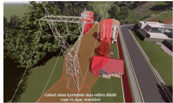
Şekil 8. EİH Gabari alanında bulunan ihlal durumları örnek görüntüsü
