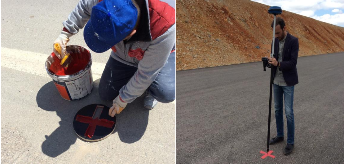
Şekil 2. Yer Kontrol Noktası İşaretleme, Tesis ve Ölçümü
