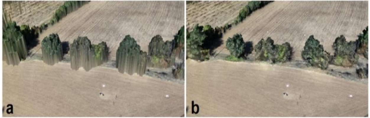
Şekil 5. Üretilen 3B katı modeller: 2.5B modelleme (a), arbitrary 3B modelleme (b)
