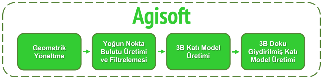
Şekil 2. Örnek SfM tabanlı görüntü eşleme yazılımı Agisoft Metashape Professional kullanılarak 3B doku giydirilmiş katı model üretim adımları
