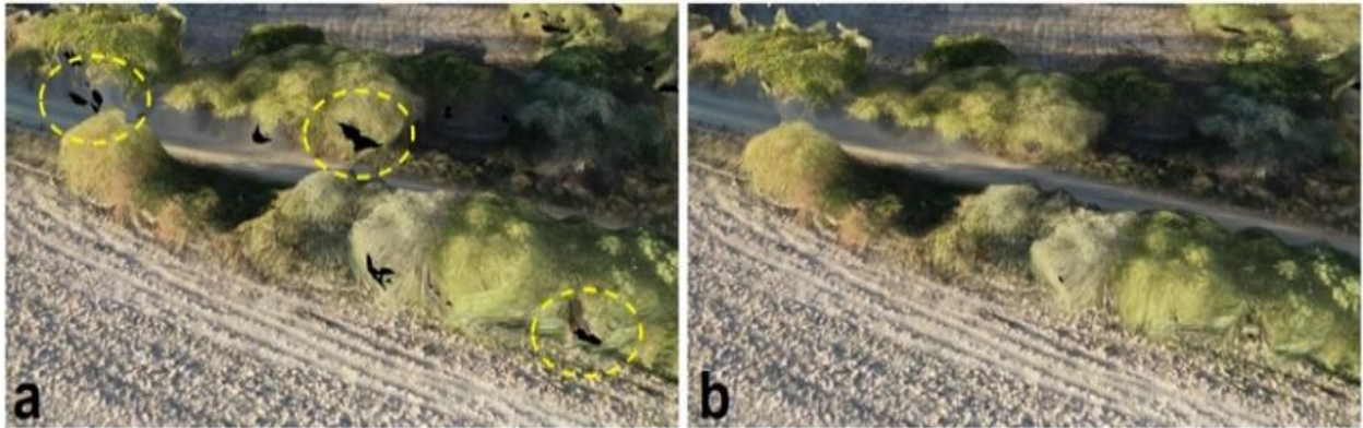
Şekil 3. Yüksek düzeyde (a) ve orta düzeyde (b) karşılıklı yöneltme kalitesi kullanılarak üretilen 3B katı model
