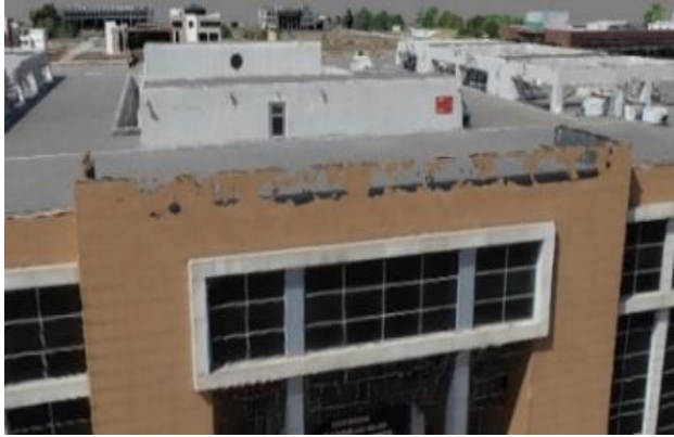
Şekil 6. Sürekli olmayan düşey bir objenin 3B katı modeldeki tasviri
