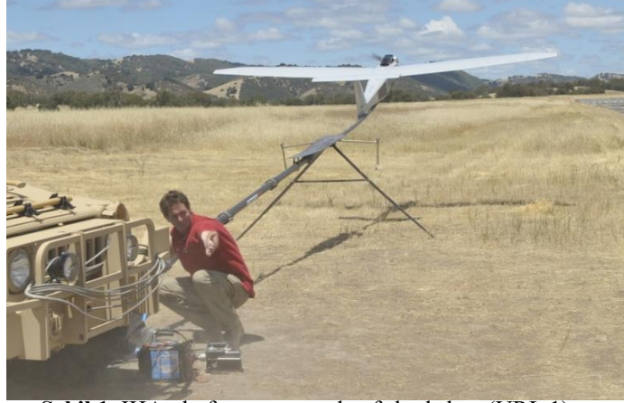
Şekil 1. İHA platformu rampadan fırlatılırken (URL 1)
