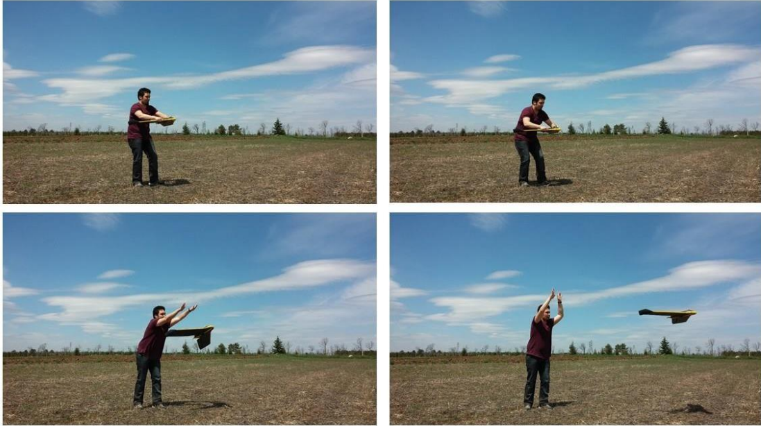
Şekil 2. El ile İHA platformu fırlatma
