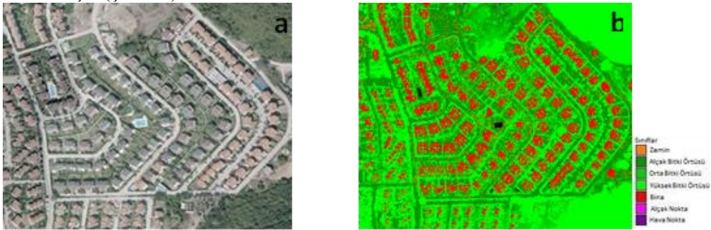
Şekil 3. Çalışma alanına ait ortofoto görüntü (a) ve standart parametreler ile kabaca sınıflandırılmış nokta bulutu (b)
