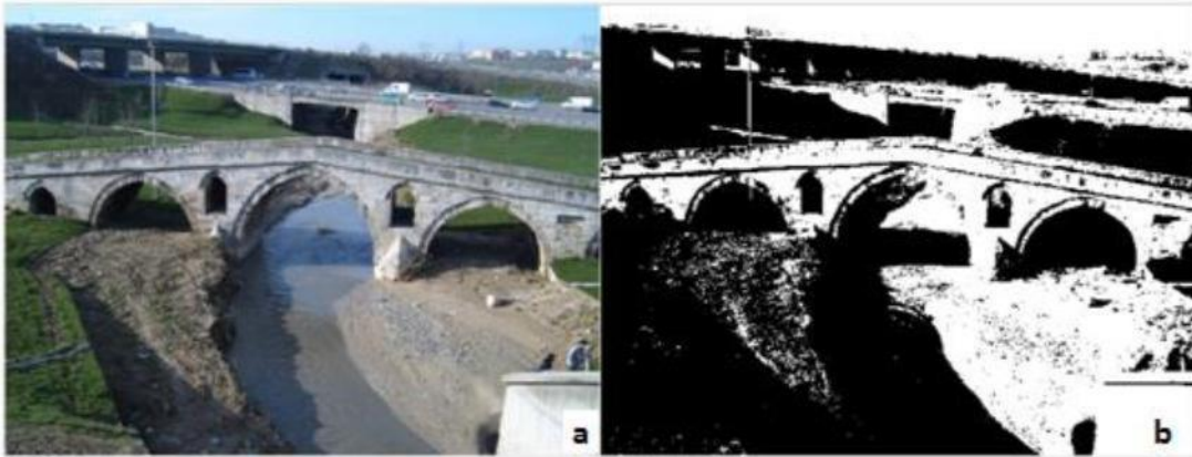
Şekil 8. a. Orijinal görüntü b. Otsu eşik metoduna göre 0.4863 sınır eşik değeri sonucunda oluşan görüntü.
