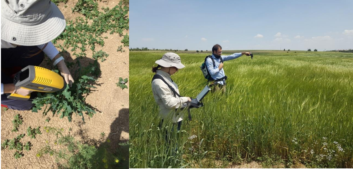
Şekil 6. ASD Quality Spec Trek (sol) ve ASD Field Spec 3 (sağ) gerçekleştirilen ölçümler.
