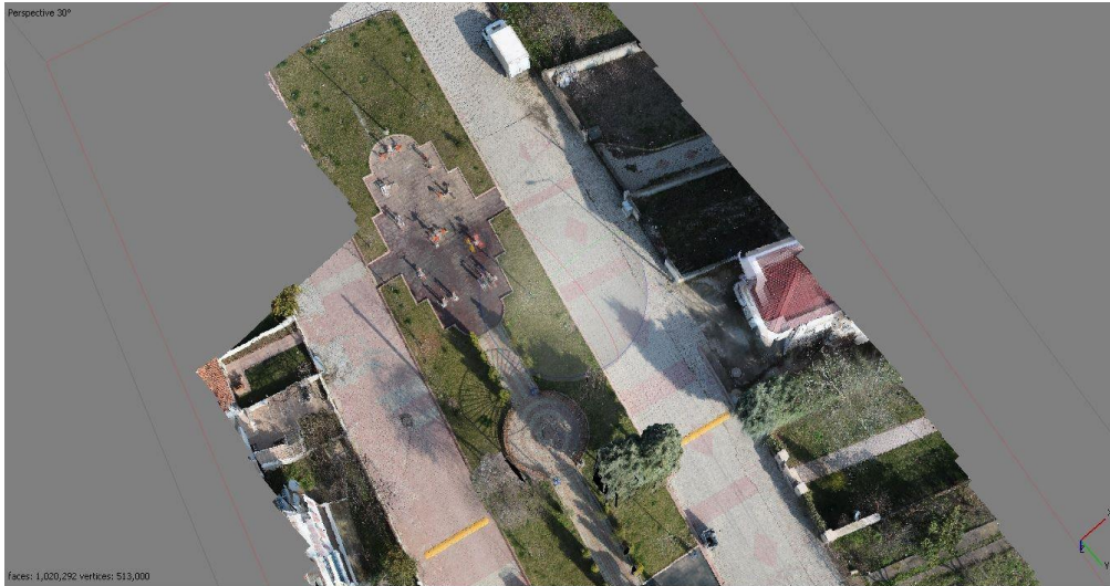
Şekil 9. Döner kanatlı İHA/multikopter kullanılarak üretilmiş olan sokak modelinin gösterimi.
