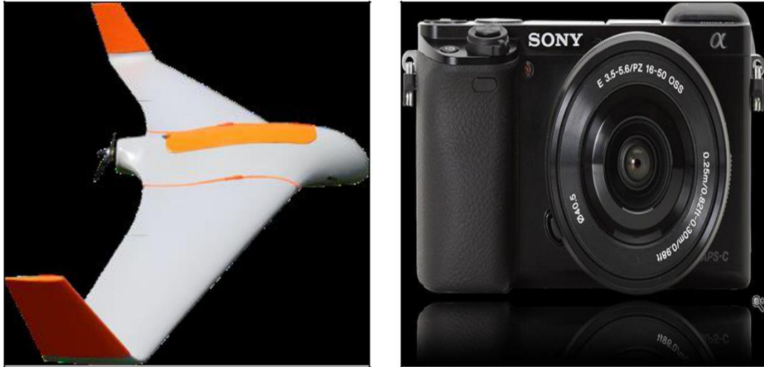
Şekil 5. Çalışma alanı 2' de kullanılmış olan sabit kanatlı İHA platformu ve İHA üzerine monte edilmiş Sony Alpha sayısal kamera.
