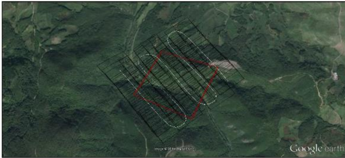
Şekil 7. Çalışma Alanı 2 için sabit kanatlı İHA kullanılarak tanımlanmış proje alanı ve İHA uçuş planının gösterimi.
