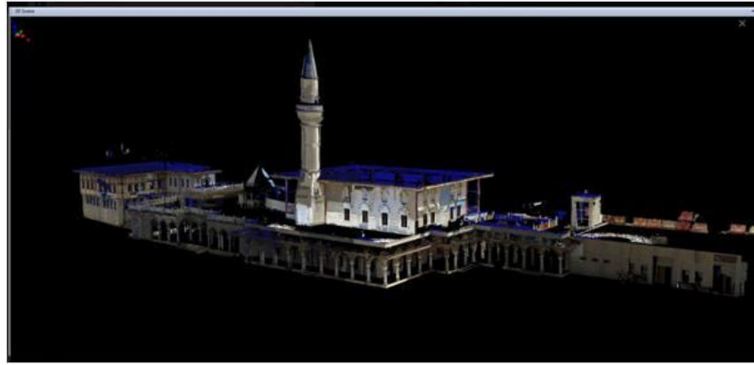
Şekil 5. TLS Sisteminden elde edilen 3D nokta bulutu modeli
