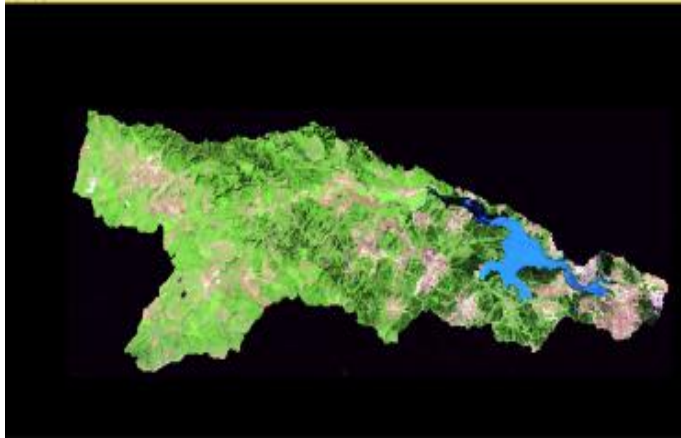
Şekil 4. Multispektral ve pankromatik görüntü ile dalgacık dönüşümü sonucu elde edilen görüntü
