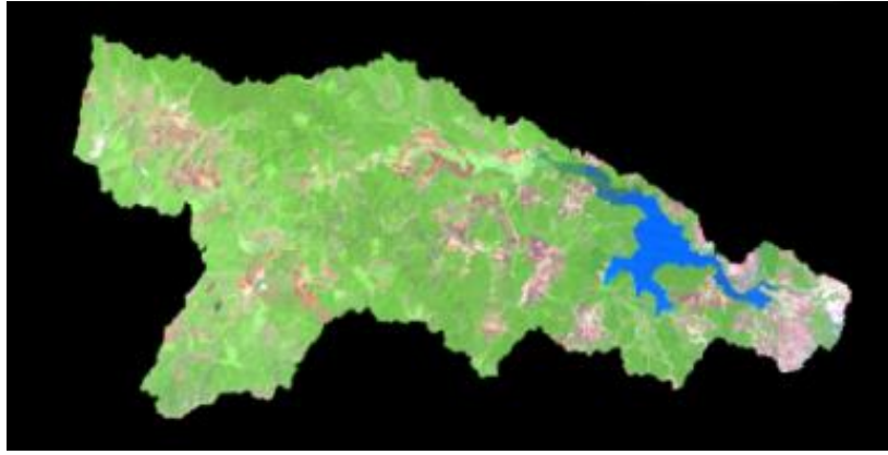
Şekil 2. Multispektral ve pankromatik görüntü ile IHS yöntemi sonucu elde edilen görüntü
