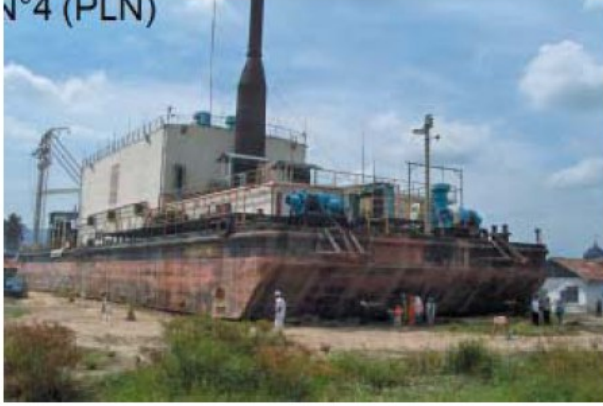
Şekil 6. Solda tsunami dalgalarıyla yer değiştiren güç üreten araç, sağda ise yer değiştiren yakıt tankı. Bu ağır nesnelere yolları üzerindeki evlere hasar verdi. (Saatçioğlu vd., 2005)
