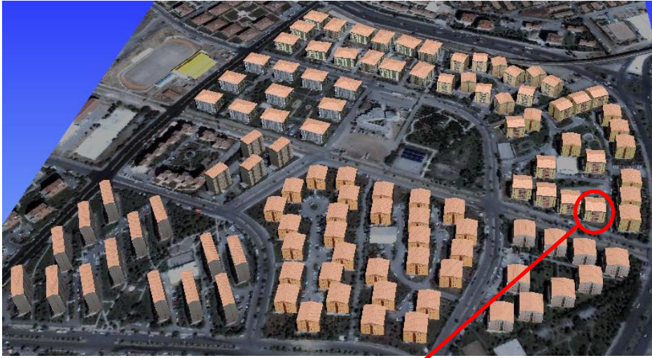
Şekil 9. Örnek bir site alanı için üretilen 3-b katı bina modelleri
