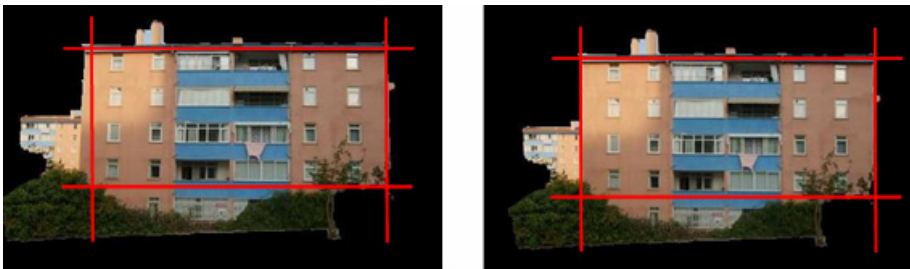
Şekil 6. Rektifikasyon işleminden önceki (sol) ve sonraki (sağ) bina cephe dokuları
