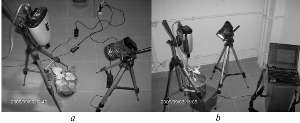
Fotoğraf 1. ASDI El Spektrometresi ile bitkilerin ölçülmesi
