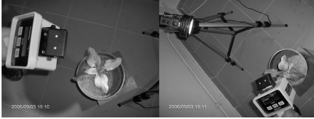
a b Fotoğraf 2. CM 1000 Klorofilmetresi ile bitkilerin ölçülmesi
